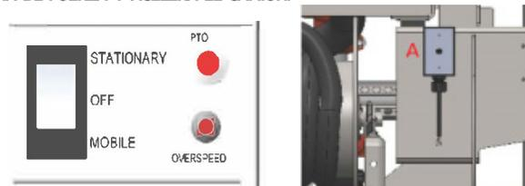
DESBLOQUEE EL CARRETE PARA LIBERAR LA MANGUERA. ABRA LA VÁLVULA DE BOLA (A). ACCIONE LA ACCELERACIÓN ESTACIONARIA (B) PARA ACTIVAR LA TOMA DE FUERZA. (ESTO PRESURIZARÁ EL SISTEMA. MANTENGA EL CONTROL DE LA MANGUERA). ES POSIBLE AJUSTAR LA BOQUILLA DE LA MANGUERA PARA REGULAR LA CANTIDAD DE AGUA. AL FINALIZAR, MUEVA EL INTERRUPTOR DE LA TOMA DE FUERZA (B), DESPUÉS CIERRE LA VÁLVULA DE BOLA (A). REBOBINE EL CARRETE DE LA MANGUERA ANTES DE MOVER EL CAMIÓN.
